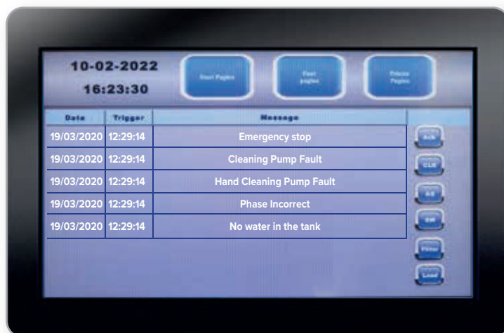
38. Foutmeldingen. (Als er een storing is met de componenten zal het in dit venster worden getoond).
